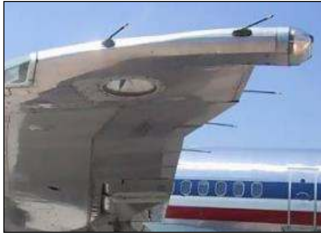
Gambar 3.6. Static Discharge System pada Pesawat Terbang
