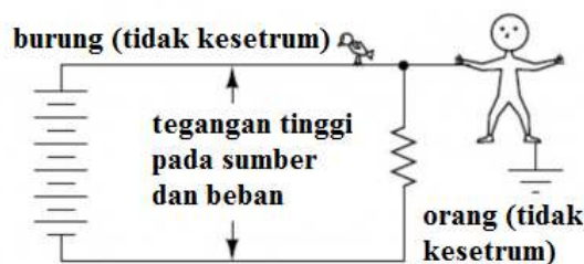
Gambar 1.53. Arus Listrik Dengan Jalur Rangkaian Tidak Lengkap
