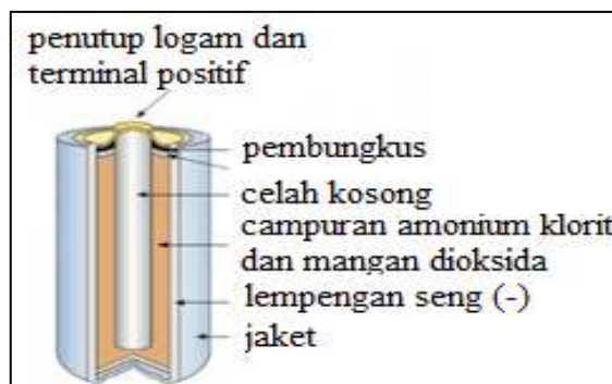
Gambar 1.11. Konstruksi Dasar Baterai
