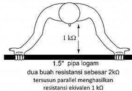
Gambar 1.58. Resistansi Pada Pipa Yang Dipegang Dengan Dua Tangan
