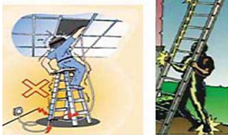
Gambar 4.19. Penggunaan Tangga Di Daerah Instalasi Listrik
