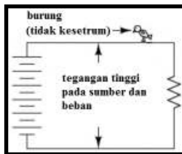
Gambar 1.50. Jalur Arus Listrik Dengan Satu Titik Kontak
