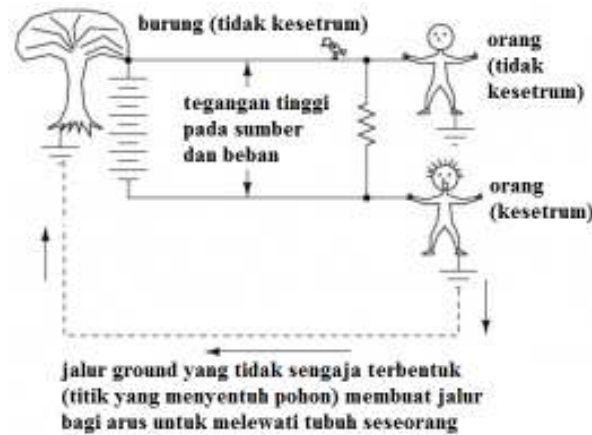
Gambar 1.55. Jalur Arus Listrik dengan Sambungan Ground Fault
